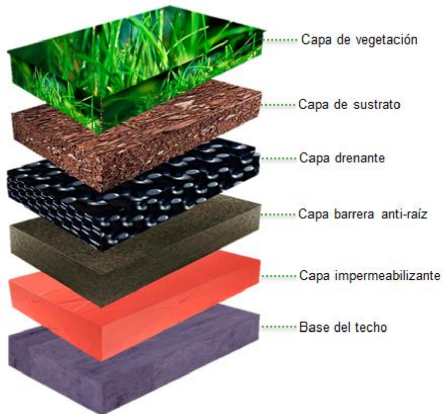
Imagen 2. Capas de un techo verde
